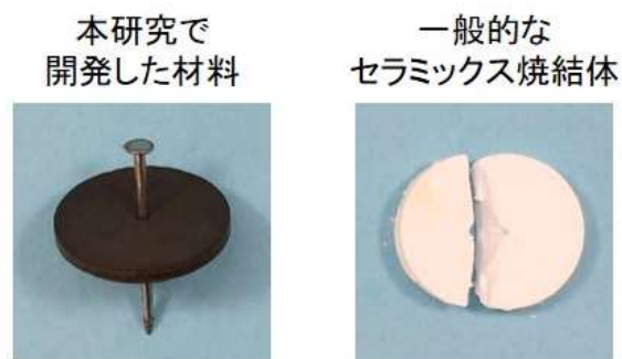
図 2. 試料に釘を打つことによる損傷許容性の定性的な評価。(左)本研究で開発した材料、(右)一般的なセラミックス焼結体。
