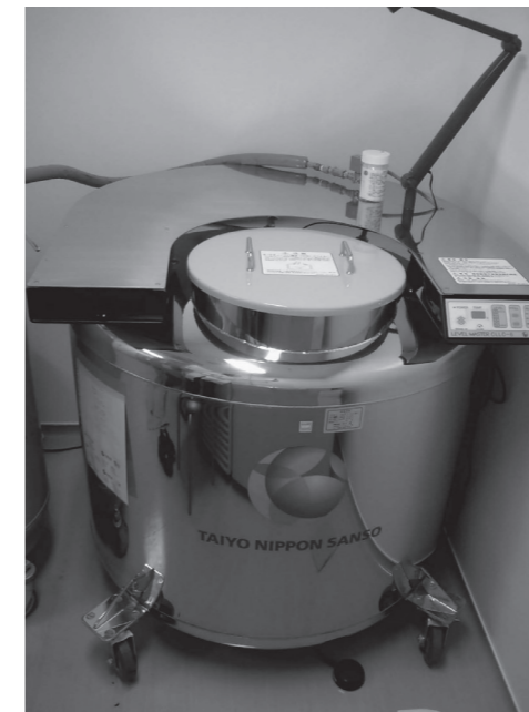
図2 大型液体窒素タンク G430-S (太陽日酸)
