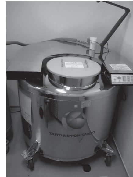
図2 大型液体窒素タンク G430-S 大陽日酸
