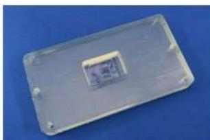
3Dプリンターによる外枠の造形
