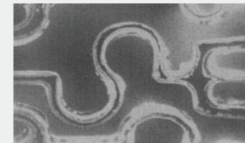
MPCポリマーで被覆したSUSの血管拡張ステント(BiodiviYsio™)。蛍光色素で標識しているために、光っている部分がMPCポリマー A.L. Lewis et al. Biomaterials 23 (2002) 1697
