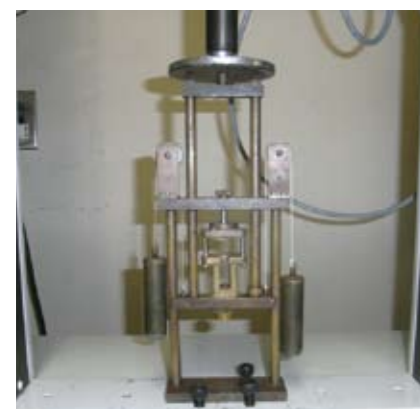
1970年代から筆者の教室で使用している接着試験装置。多くの論文発表、製品開発に貢献してきた
