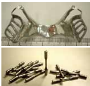
最近金属材料分野で開発された材料・高延性コバルトクロム合金(上)、低磁性ジルコニウム合金(下)
