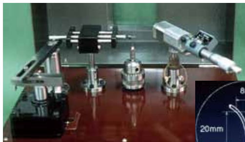
繰り返し曲げ試験の試験機並びに模式図
