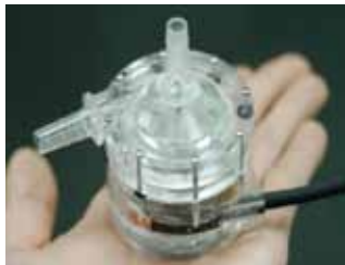
小児用補助人工心臓TinyPump
