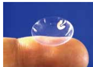
ソフトコンタクトレンズ型バイオセンサ
