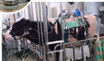
(上)小児用補助人工心臓ポンプ。 (下)子牛を用いた磁気浮上遠心血液ポンプの実験。約半分の血液循環を体外の人工心臓で行い、デバイスの安全性を検証する。
