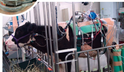
(上)小児用補助人工心臓ポンプ。 (下)子牛を用いた磁気浮上遠心血液ポンプの実験。約半分の血液循環を体外の人工心肺で行い、デバイスの安全性を検証する。
