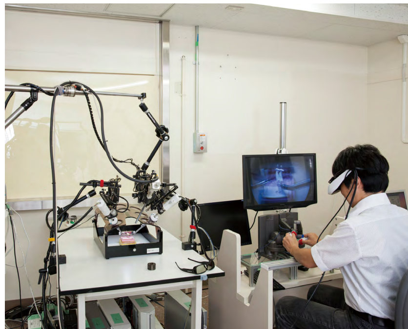
頭の動きで操作できるモーター駆動型内視鏡ホルダー「エアロビジョン(仮)」。動作検証に来ていた外科医は、基本的な動作の完成度を高く評価したうえで「あともう少し動きが滑らかになることと、トラブル時のリスクマネジメントがしっかりしていれば実用化できる」と太鼓判を押す。
