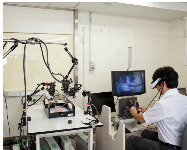
頭の動きで操作できるモーター駆動型内視鏡ホルダー「エアロビジョン(仮)」。動作検証に来ていた外科医は、基本的な動作の完成度を高く評価したうえで「あともう少し動きが滑らかになると、トラブル時のリスクマネジメントがしっかりしていれば実用化できる」と太鼓判を押す。
