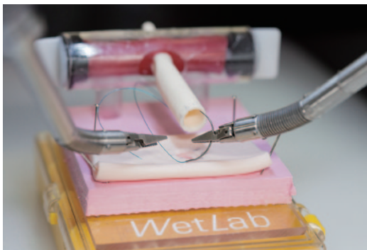
ロボットアームの先端についている鉗子は、体外に4個、体内に2個、計6個の関節がある。通常は外側4個の関節だけで、体内では軸を中心に回転させることしかできないが、体内部分にも関節があるので手首のように曲げることができる。
