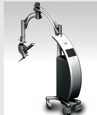
頭部センサー連動で空気圧駆動による内視鏡ホルダー「EMARO」。
