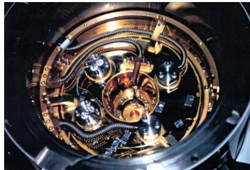
図5 クライオ電子顕微鏡用ステージ。液体窒素タンクを外した状態で液体ヘリウムタンクとポットが見える。
