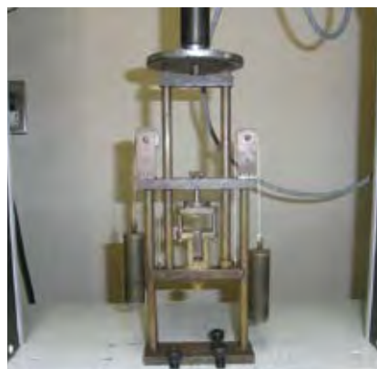
1970年代から筆者の教室で使用している接着試験装置。多くの論文発表、製品開発に貢献してきた
