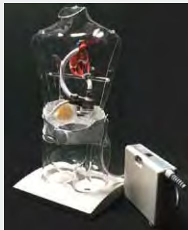
サンメディカル技術研究所が発売した植え込み型補助人工心臓「EVAHEART(エヴァハート)」。体内に埋め込まれる血液ポンプは電気で駆動し、体外のコントローラで制御される (写真提供: サンメディカル技術研究所)
