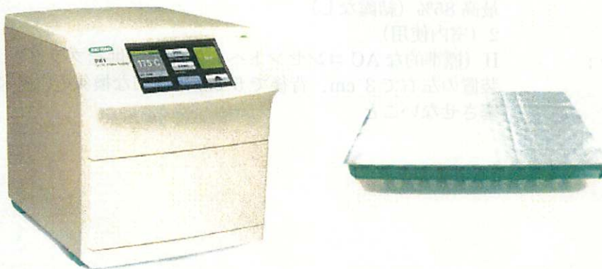
PX1 PCR Plate Sealer (左側) と密閉された 96 ウェルプレート (右側)
