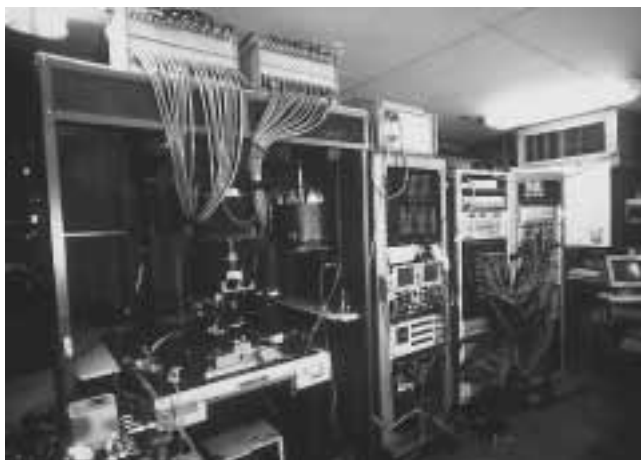
第二生理学教室（現・機能協関システム医学分野）で作製された膜電位の光学的計測システム
