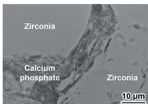
図1 ジルコニア/リン酸カルシウム複合体の微細構造
