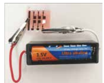
図3 乾電池1本で発光する有機EL(Adv. Opt. Mater. 2022)
