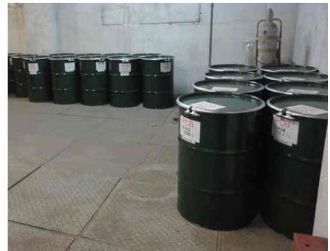
高濃度PCB廃棄物保管中の状況
