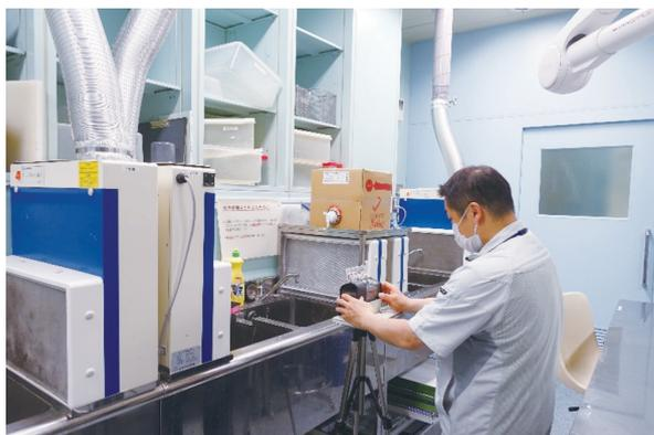
固体捕集法によるサンプリング
