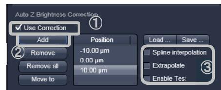
\*Spline Interpolation にチェックを入れると、曲線的に各深さポイント間での画像取得パラメータの補間を行います。
