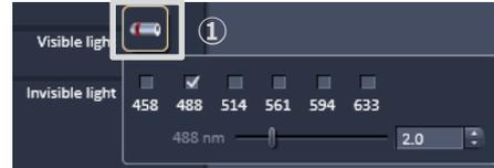
Fig. 2 レーザの選択とパワーの設定
