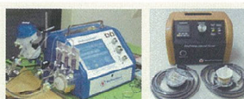
命を守る小型・高機能心肺補助装置(左)と充填血液量が5mlに超小型化された小児用、遠心式補助人工心臓(右)
