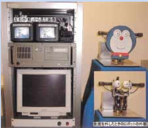
眼球運動神経システムモデルと同じ制御システム構造を持つロボットの「眼」
