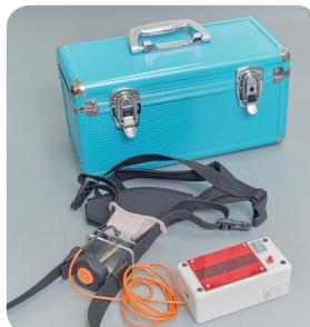
戸原診療科長が自ら開発した、口を開く力測定器(特許出願中)。口を開ける力具合で嚥下障害のスクリーニングができる。
