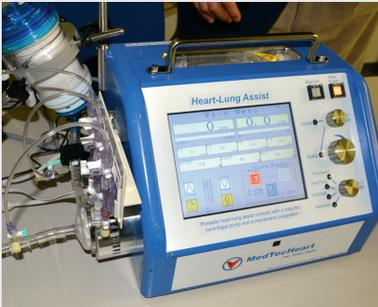
NEDO(新エネルギー・産業技術総合開発機構)の助成金を用い開発が進められている、ディスプレイ式、磁気浮上遠心血液ポンプ式、高機能ポータブル心肺補助装置。
