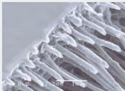
樹脂含浸層。浸み込んで固まることが接着の原点であり、分子結合よりも耐久性が期待できる(写真提供：サンメディカル)
