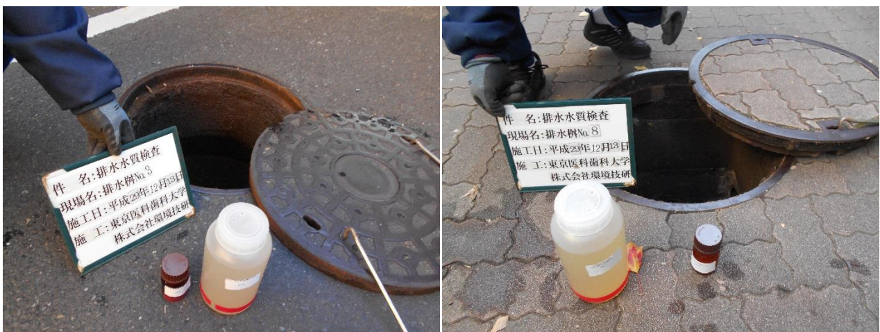
於：湯島地区 排水水質分析検査の排水の採取状況（2017年12月）
