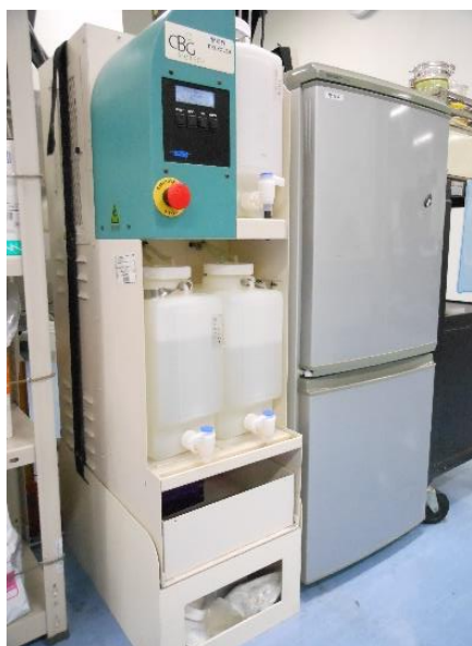
於：有機溶媒蒸留再生装置
