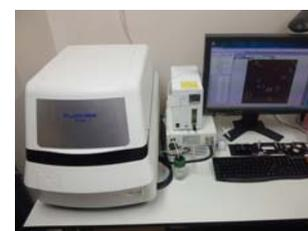
共焦点レーザー走査型顕微鏡
