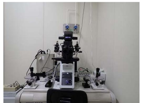
図2 インジェクション用倒立顕微鏡
