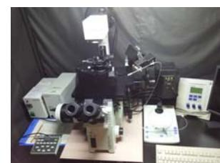
倒立型電動蛍光リサーチ顕微鏡
