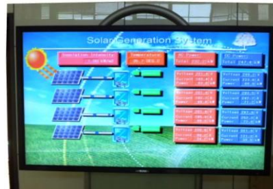
野口研玄関に設置された運転状況を示す画面
