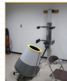
肢切断者の断端を3次元的に計測する CAPODシステム
